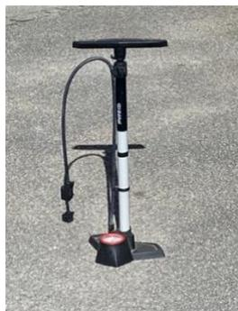
La pompe à pied avec manomètre fait partie des outils indispensables à tout cycliste qui se respecte. Avec celle-ci est livré le mode d'emploi suivant « la pression optimale, en bars, correspond à ton poids divisé par 10, dans la limite des préconisations écrites sur le pneu ». Autrement dit, le cycliste de 75 kg doit gonfler son pneu à 7,5 bars. Cela s'applique au routier, car la pratique du VTT ou de la piste implique d'autres règles.
